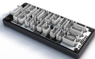
Geeignet für alle Lithium Batterien. Kompatibel mit 2S-6S Hardplastik Akkus mit EH, TP, XH oder HP Balancer-Anschlüssen.
